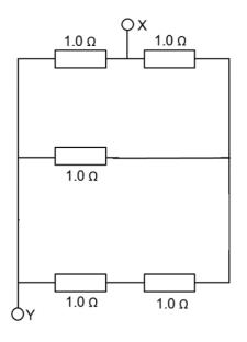
1  $\Omega$  // 2  $\Omega$  = 0.66667  $\Omega$ 1  $\Omega$  // 1.66667  $\Omega$  = 0.625  $\Omega$ = 0.63  $\Omega$  (2 SF)
